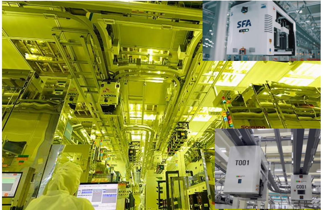
<그림3>. 반도체 웨이퍼 이송장치(OHT;Overhead Hoist Transport)
